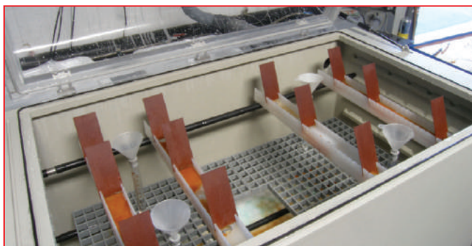
Câmara para teste de corrosão do aço inoxidável em nevoeiro salino. Chamber for STAINLESS STEEL corrosion tests in a saline mist.
