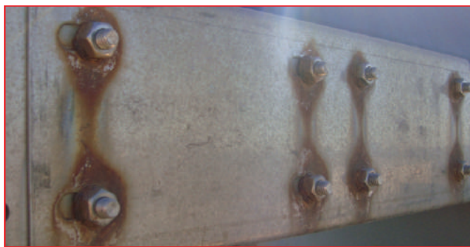
Exemplo de corrosão galvânica causada pelo acoplamento de porcas e parafusos de aço inoxidável numa placa de aço.
