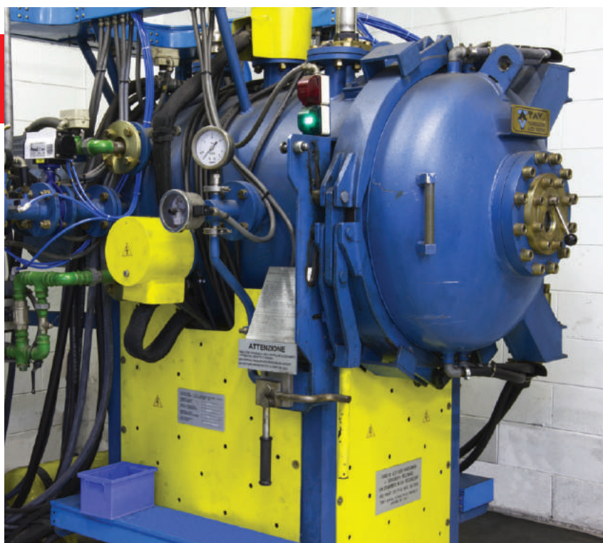
Forno de têmpera a vácuo para tratamento térmico. Vacuum furnace for heat treatment.
